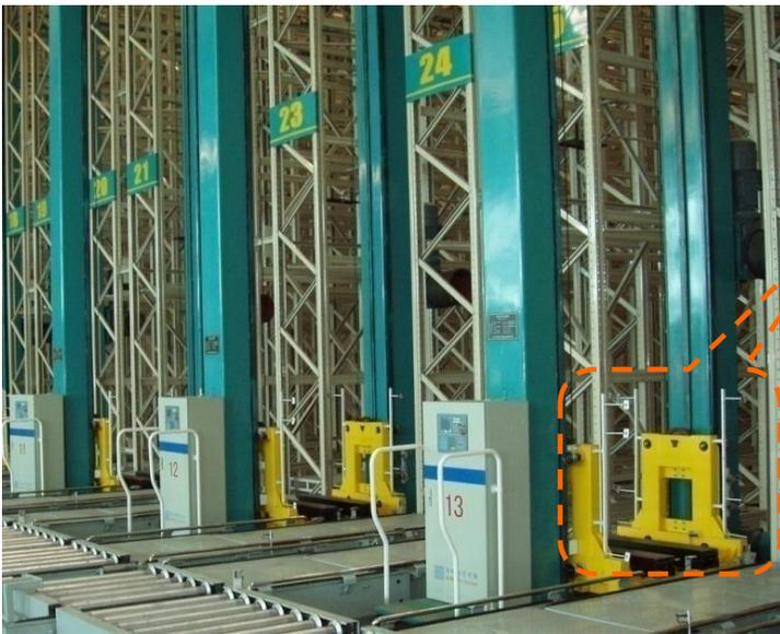
载货台表面涂装工艺: 采用磷化—环氧树脂塑料粉末静电喷涂—烘烤固化方式, 表面美观, 附着力强, 耐腐蚀, 使用寿命长。
